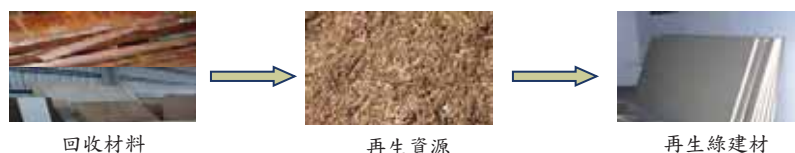
圖 6-2 木質材料回收製造再生綠建材流程
